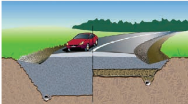
Fig. 5.5.2: Leca Lettklinker brukt som frostsikring reduserer gravedybde.
