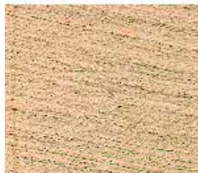
Kostet Weber.base 261 Fiberpuss. Malt med Weber.ton 303 Silikatmaling
