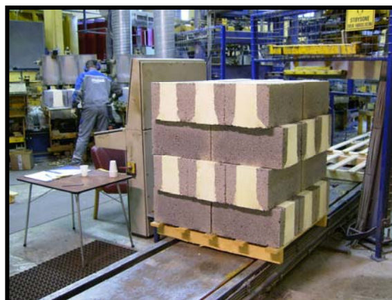
Ferdigprodusert palle med iso-blokk, klar for utkjøring til lager
