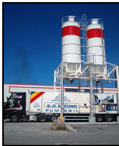
Påfylling av mørtel på bil
