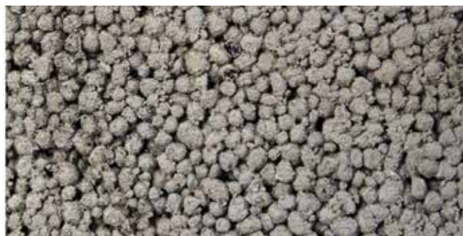
Figur 3.6 Porøsitet i Leca lettklinkerbetong
