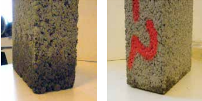
Figur 3.7 Vannoppsug test for Leca blokker av ulik type. Til venstre tradisjonell Leca blokk. Til høyre LSX blokk som viser klart redusert kapillær sugeevne.
