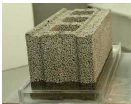
Fuktoppsug i Leca blokker
