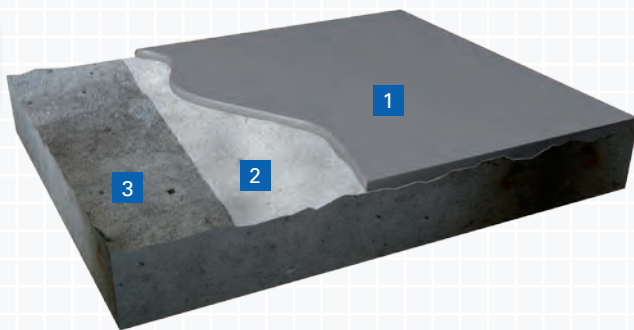
Figur C.6.1 Avretting på betong.
