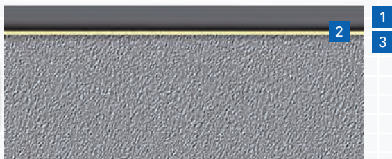
Figur C.6.5 Avretting på Leca Byggeplank.
