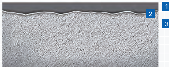
Figur C.6.6 Fuktsperre med herdeplast.
