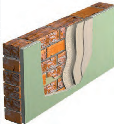
Figur B.8.1 Sjematisk fremstilling av puss-reparasjon.
