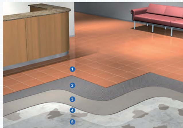
Figur C.9.1 Weber Hurtiggulv - Gulv med belegg.
