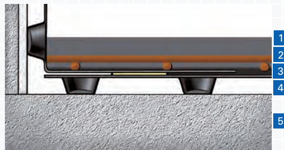
Figur C.6.8 Fuktsperre med luftspaltende belegg.
